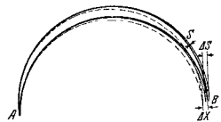
Рис. 49. Пути ионов двух изотопов с мало различающимися массами в электромагнитном сепараторе.
